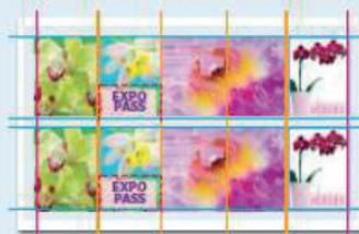
refilado, corte, hendido, perforado, y perforado en cruz en un solo paso
