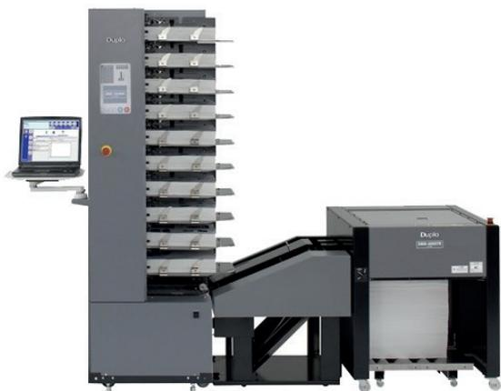
Cuenta con un contador de 5 dígitos (ascendente y descendente); correas gemelas verticales para la transportación del papel, auto calibración; selección de salida por la parte izquierda o derecha; selección de bandeja automática e inserción de cubierta u hojas intercaladas
